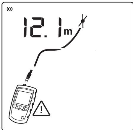
图 21. 同轴电缆布线中存在短路
