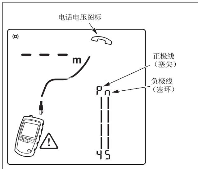
图 11. 检测到电话电压
