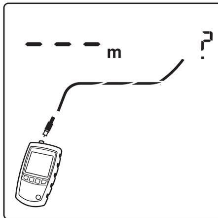
图 22. 同轴电缆布线中存在未知端接
