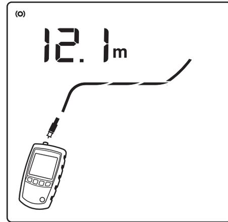
图 20. 同轴电缆布线中存在开路
