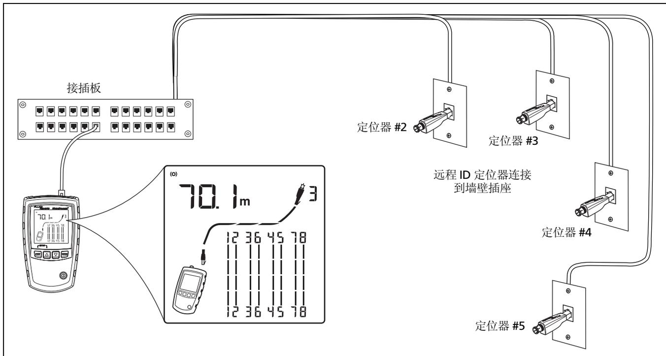
图 15. 使用多个远程 ID 定位器
